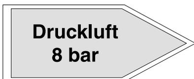
Bild 9.17 : Kennzeichnungsschilder mit Klartext
